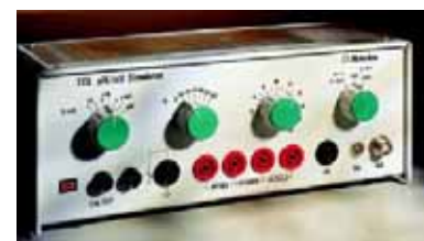
Fig. 9. Simulador eléctrico de pH (mV).
